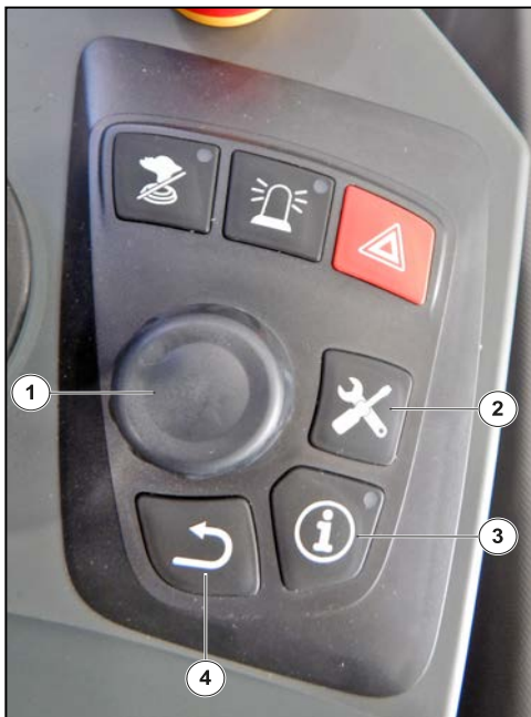
Afbeelding 75: Bediening van het display
