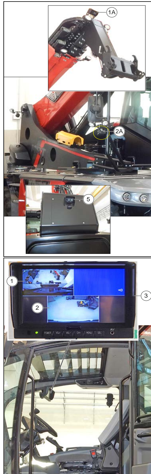
Afbeelding 114: Camerasysteem aan de voor- en zijkant
